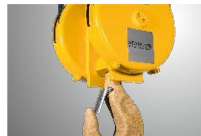
El tipo de protección utilizado es Seguridad constructiva »c« y no se usa el aluminio. En caso de elevadas velocidades de desplazamiento se aplica una capa de bronce a determinadas piezas, como por ejemplo, el gancho de carga.
