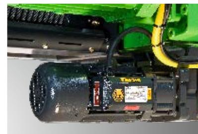
Los motores para Zona 1 y Zona 21 están hechos de hierro fundido gris y el tipo de protección es una combinación de Envoltorio antideflagrante »d«, Seguridad aumentada »e« y Protección mediante envoltorio »tD«. Los motores para Zona 2 son de aluminio y en el tipo de protección Medios de servicio que no generan chispas »nA«. Los motores para Zona 22 están concebidos en IP 66 y Protección mediante envoltorio »tD«.
