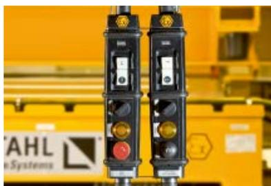
En los polipastos de cable para atmósferas explosivas para la zona 1 se emplea la botonera de mando SWH ex de dos fases con el tipo de protección IP 66.
