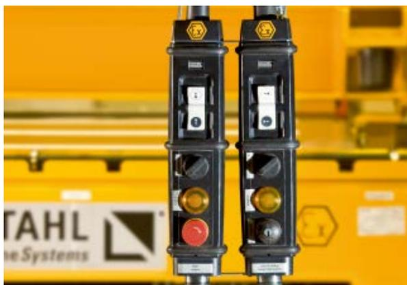
Las botoneras SWH 5ex han sido especialmente concebidas para controlar los polipastos y grúas en un entorno potencialmente explosivo. El accionamiento suele ser de dos etapas y permite cambiar rápidamente de «rápido» a «lento» y viceversa. Todas las botoneras tienen un pulsador de PARADA DE EMERGENCIA que cumple con la norma IEC/EN 60947-5-5.
