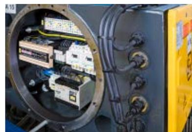
Tipo de protección de las cajas de mando en Zona 1, Zona 2 y Zona 21 en grúa y polipasto combinado a partir de los tipos de protección envolvente antideflagrante «d», Seguridad aumentada «e» y Protección mediante envolvente «D».
