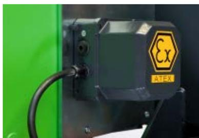
El tipo de protección del final de carrera del engranaje es IP 66. Los elementos de montaje están protegidos mediante un encapsulado »d« resistente a la presión y la caja mediante una mayor seguridad »e«.
