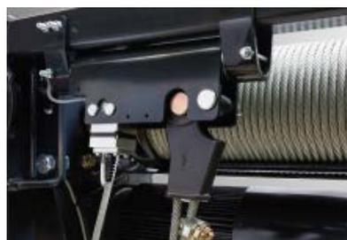
La desconexión por sobrecarga se realiza mediante un sensor de carga de dos canales que emite señales analógicas. Según el enhebrado se emplean sensores diferentes (LCD, LSD).
