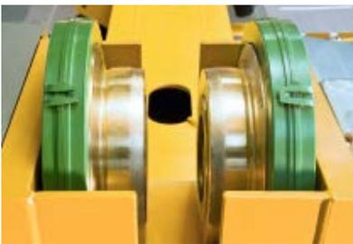
El tipo de protección de todas las ruedas es la seguridad constructiva «c». Las ruedas se fabrican, entre otros materiales, de latón cuando las velocidades de desplazamiento son elevadas.
