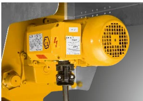
Los motores de traslación en versión antideflagrante para Zona 1 y Zona 21 han sido diseñados para el funcionamiento intermitente. Disponen de un motor con rotor de freno deslizante, freno cónico y masa de inercia para un comportamiento confortable de arranque y frenado. Todos los motores permiten la conmutación de sus polos para dos velocidades de traslación. La reductora especialmente silenciosa apenas requiere mantenimiento gracias a la lubricación permanente en baño de aceite.
