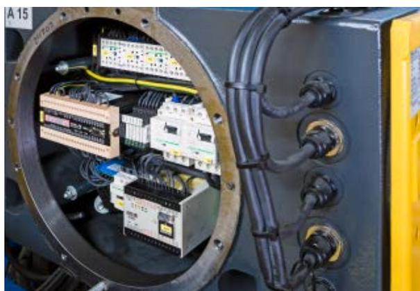
Envolvente antideflagrante para Zona 1 y Zona 2: La caja hecha de chapa de acero o aluminio se puede utilizar como caja individual o como combinaciones de caja. Todos los componentes necesarios como transformadores, contactores, fusibles, instrumentos de medición y dispositivos de activación se pueden montar en la caja concebida según el método modular. Con pasamuros se establece la conexión con el compartimento de conexiones (seguridad aumentada Ex e).
